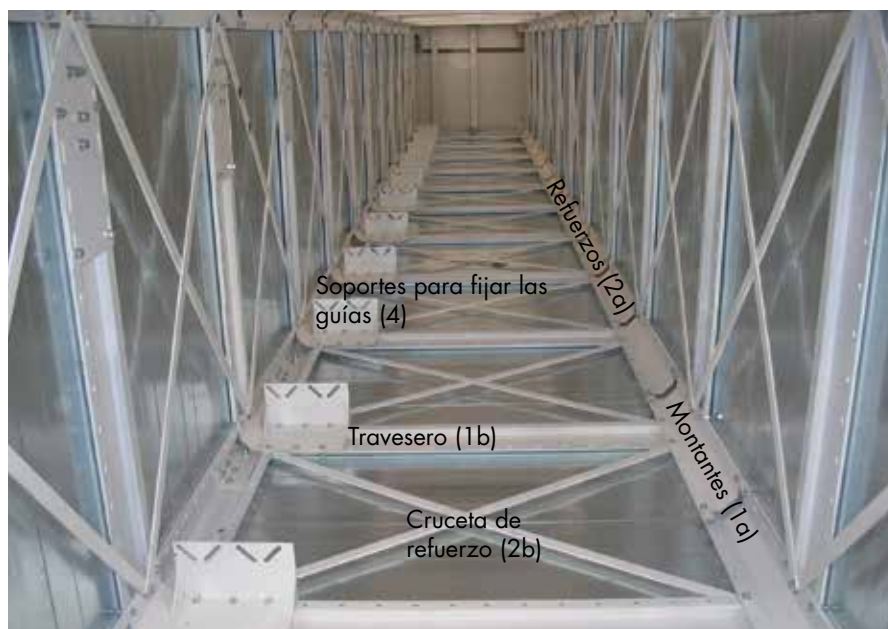
Fig. 2: Componentes de la estructura modular polivalente DICTATOR
