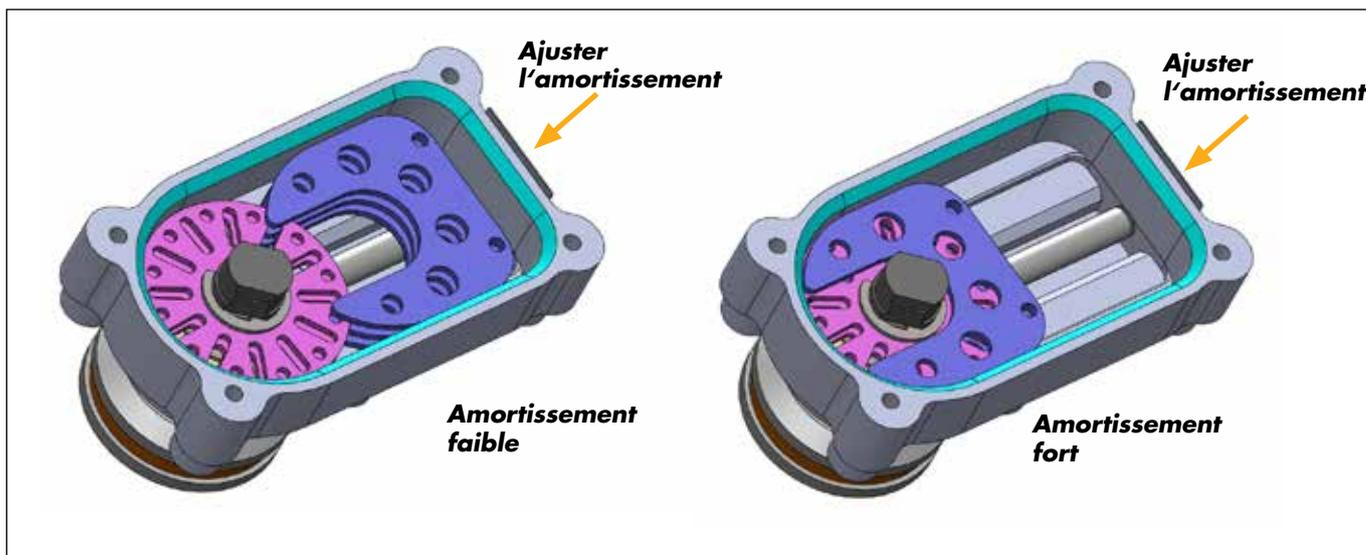
L'ajustage des amortisseurs type **RD 240/241** se fait par une vis sur le côté du boîtier en aluminium.
