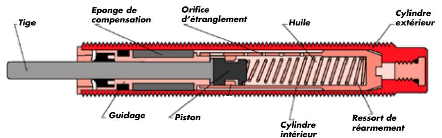
Les amortisseurs de grande capacité construits pour **une moindre absorption** d'énergie disposent seulement d'un orifice d'étranglement. Celui-ci est ajusté par une **vis à réglage au fond du cylindre**.
