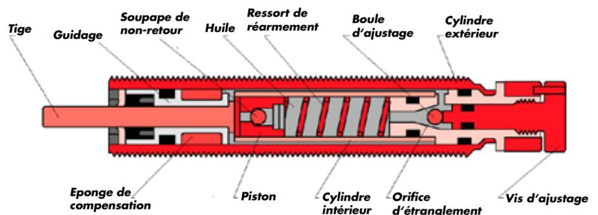
Les amortisseurs de grande capacité construits pour une **absorption d'énergie très haute** sont réglés par une **vis d'ajustage située sur le côté** du cylindre. Celle-ci ouvre ou ferme les plusieurs orifices d'étranglement du cylindre intérieur
