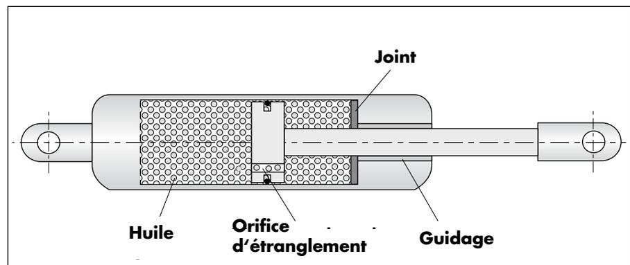
Les **amortisseurs en montage fixe avec réglage** utilisent le réglage à dents des amortisseurs de fin de course. On adapte l'amortissement en tirant et tournant la tige.
