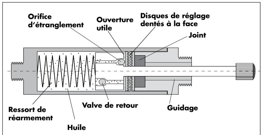
Avec le réglage à dents on ajuste l'orifice d'étranglement dans le piston par une vis d'ajustage dans la tige. Ça permet un réglage très exacte. La tige d'ajustage change la position de la boule dans l'orifice d'étranglement : le plus elle est à l'arrière, le plus d'huile peut passer, ça veut dire le plus faible est l'amortissement.
